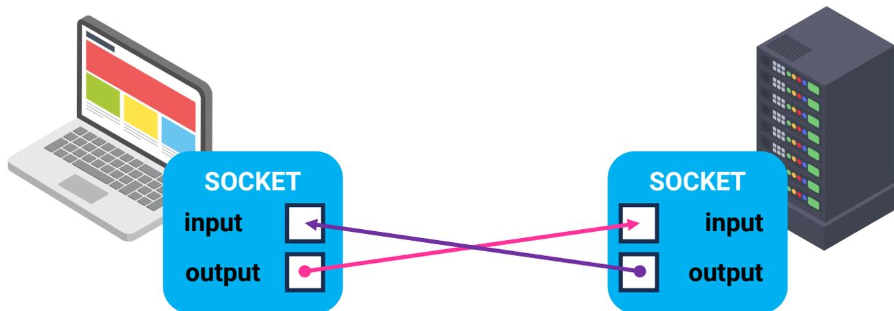
Le client et le service dispose chacun d'une socket (ou équivalent) pour gérer la connexion qui les relie tous les deux. Une connexion HTTP ne relie qu'un seul client à un seul service.
